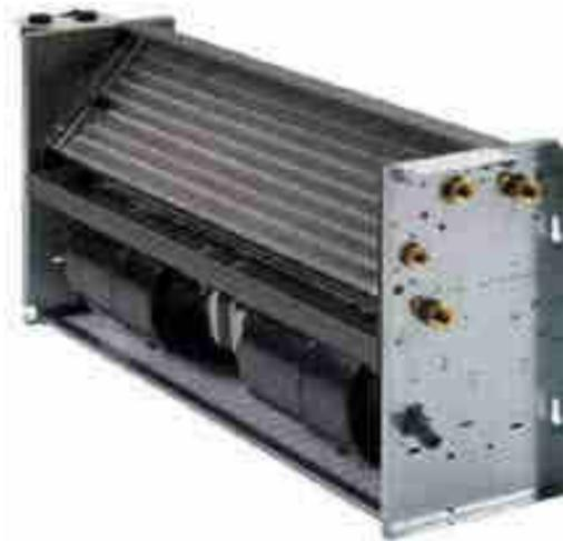
La struttura interna di un ventilconvettore. L'aria viene aspirata dai ventilatori nella parte inferiore, passa attraverso il filtro e la batteria, riscaldante o raffreddante, e viene quindi immessa in ambiente. L'apparecchio può essere ricoperto da una cofanatura in lamiera verniciata oppure essere inserito in un elemento di arredo o in una nicchia.
