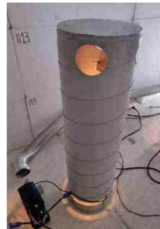
Dispositivo per la simulazione del carico termico dovuto ad una persona.
