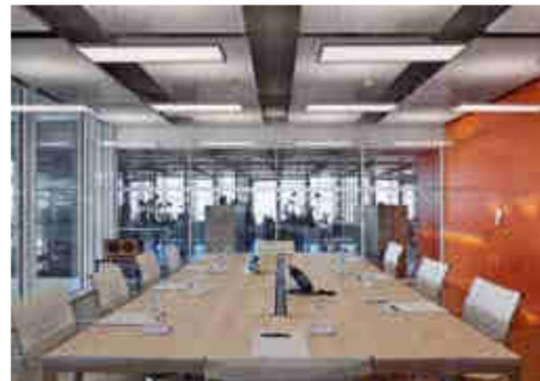
Sala riunioni con soffitto integrato con pannelli, lampade, diffusori d'aria e sensoristica. Le parti più scure mostrano il solaio che opera l'attivazione termica della massa.
