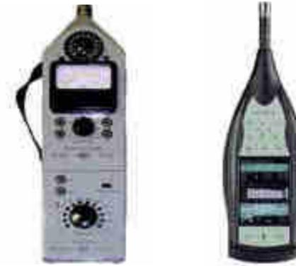
I fonometri analogici degli anni '60 (a sinistra) permettevano la sola visualizzazione istantanea della grandezza misurata e non potevano memorizzare alcun dato. I fonometri digitali, dagli anni '90 (a destra) consentono la misura simultanea di diverse grandezze, memorizzano rilevanti quantità di dati e possono essere programmati per eseguire specifiche misure.
