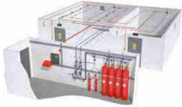
*Esempio di impianto antincendio a saturazione d'ambiente mediante gas estinguente. Il gas è contenuto ad alta pressione in bombole e viene distribuito attraverso una rete di tubazioni e ugelli di immissione. In presenza di persone (tipicamente durante le ore lavorative) la procedura di scarica, avviata dall'impianto di rivelazione, richiede un consenso ad avvenuta evacuazione.*
